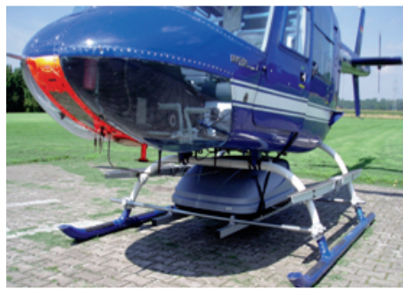
Trägerbox am Hubschrauber mit integriertem Lasersystem, GPS/INS und Elektronik
