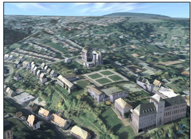
Digitales Gebäudemodell (LoD 2) mit detaillierten Dach- und Fassadenstrukturen auf Grundlage eines Digitalen Geländemodells
